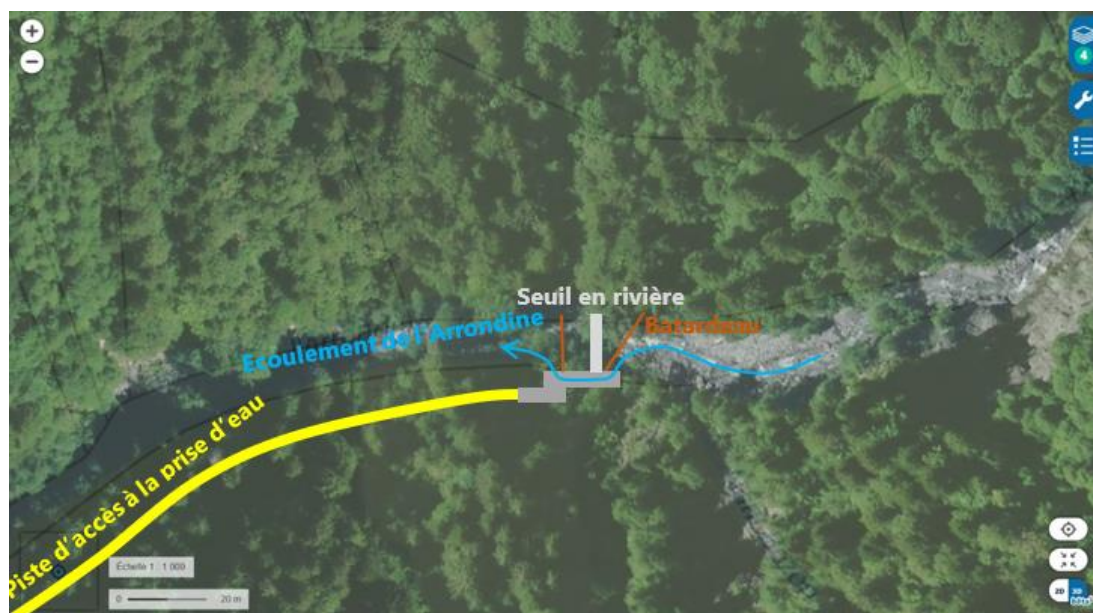
Figure 31: Phase 2 : Construction du seuil en rivière
